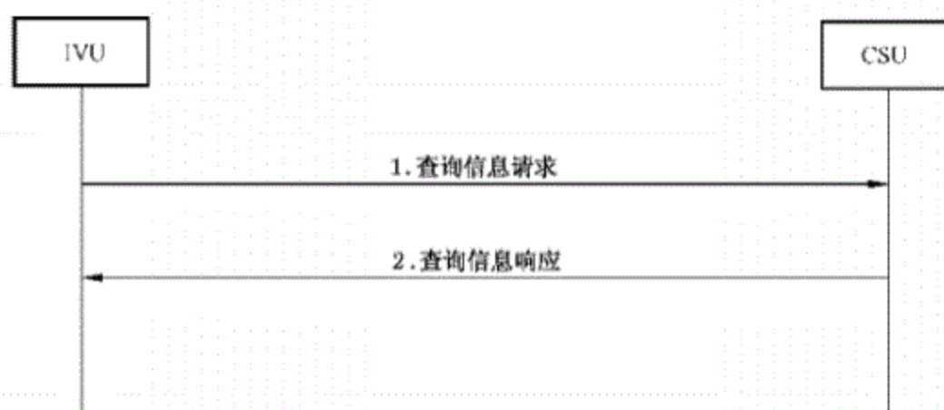
图 30 IVU 向 CSU 发起信息查询过程
